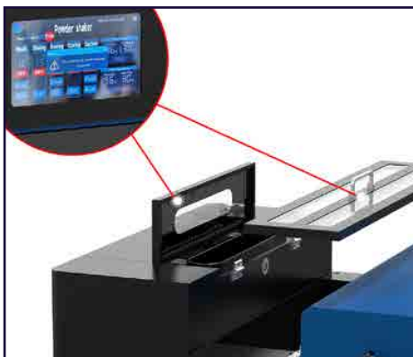
Protección por apertura de tapa
