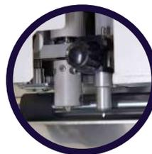
Doble cabezal: Corte + hendido
