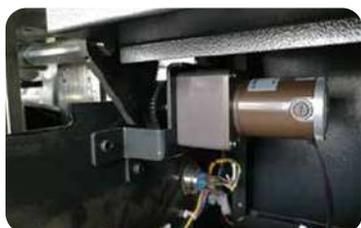
Sistema eléctrico de elevación de los rodillos de presión. Fácil de operar. Precisión garantizada.
