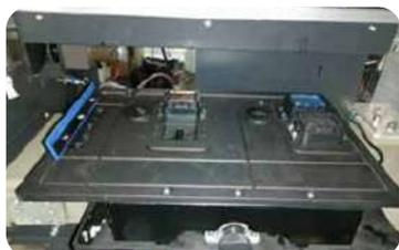
Plataforma de limpieza de cabezales. Mejora la precisión de la humedad de la tinta en el capping.
