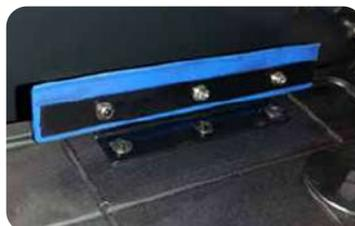
Limpieza de cabezales mediante hoja grande. Mejora la eficiencia a la hora de realizar la limpieza.
