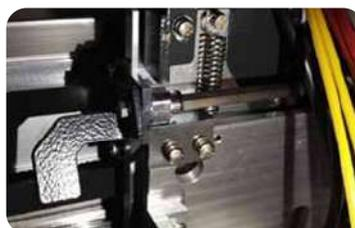
Ajuste de la altura de los cabezales. Fácil de regular a la hora de imprimir en distintos espesores.
